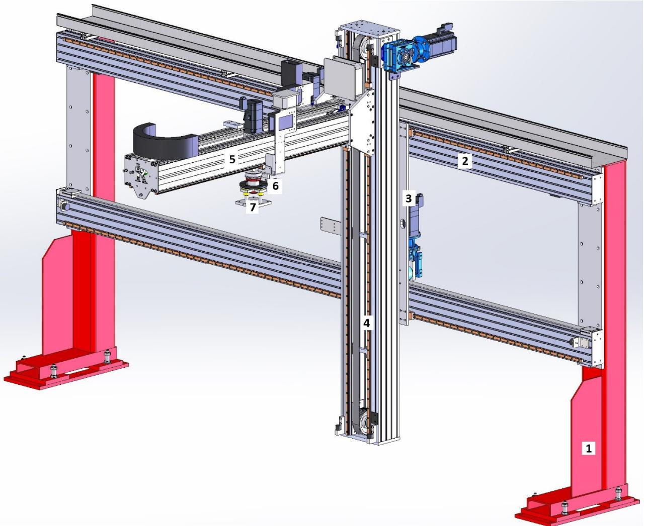
(1) L'**unità di sostegno verticale** è in acciaio, sabbiata e verniciata con polvere epossidica colore rosso RAL 3001. Sulla base d'appoggio sono applicate due piastre con regolazioni e blocaggi di tipo concentrico. Una nervatura di rinforzo unisce il tubolare verticale alla base garantendo così un'elevata rigidità e stabilità all'intero sostegno.
