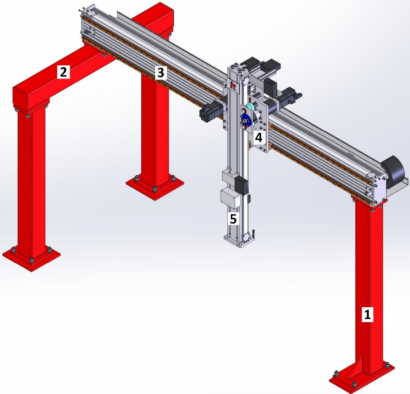
**(1)** L'unità di sostegno verticale è in acciaio, sabbiata e verniciata con polvere epossidica RAL3001 (rosso). Alle estremità sono applicate delle piastre con regolazioni e bloccaggi di tipo concentrico (**A**). In funzione di carichi, dimensioni e velocità possono essere applicate delle nervature (**B**) di rinforzo e/o aumentate le dimensioni delle piastre di fissaggio (**C**).
