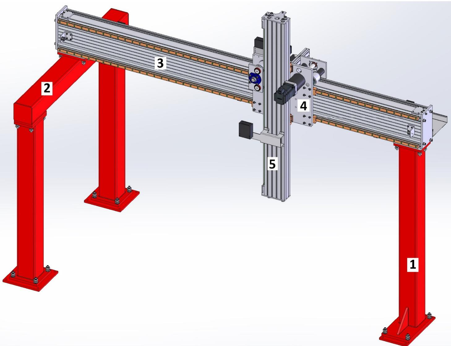
**(1)** L'unità di sostegno verticale è in acciaio, sabbiata e verniciata con polvere epossidica RAL3001 (rosso). Alle estremità sono applicate delle piastre con regolazioni e bloccaggi di tipo concentrico (**A**). In funzione di carichi, dimensioni e velocità possono essere applicate delle nervature (**B**) di rinforzo e/o aumentate le dimensioni delle piastre di fissaggio (**C**).
