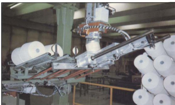
▲ Unità di presa a forche per rocche. Fork gripping unit for yarn packages.
